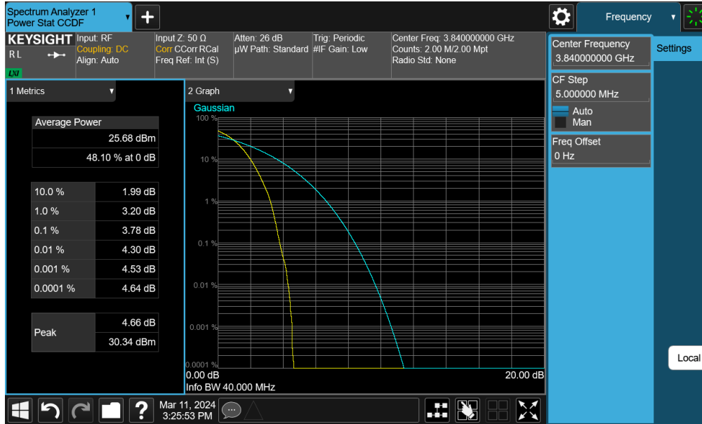
Plot 7-152. PAR Plot (NR Band n77 - 40MHz DFT-s-OFDM-BPSK – Full RB – Ant2)
