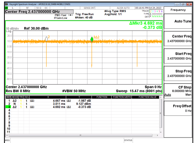
DUTY CYCLE 802.11be EHT20 242T MODE, 2TX
