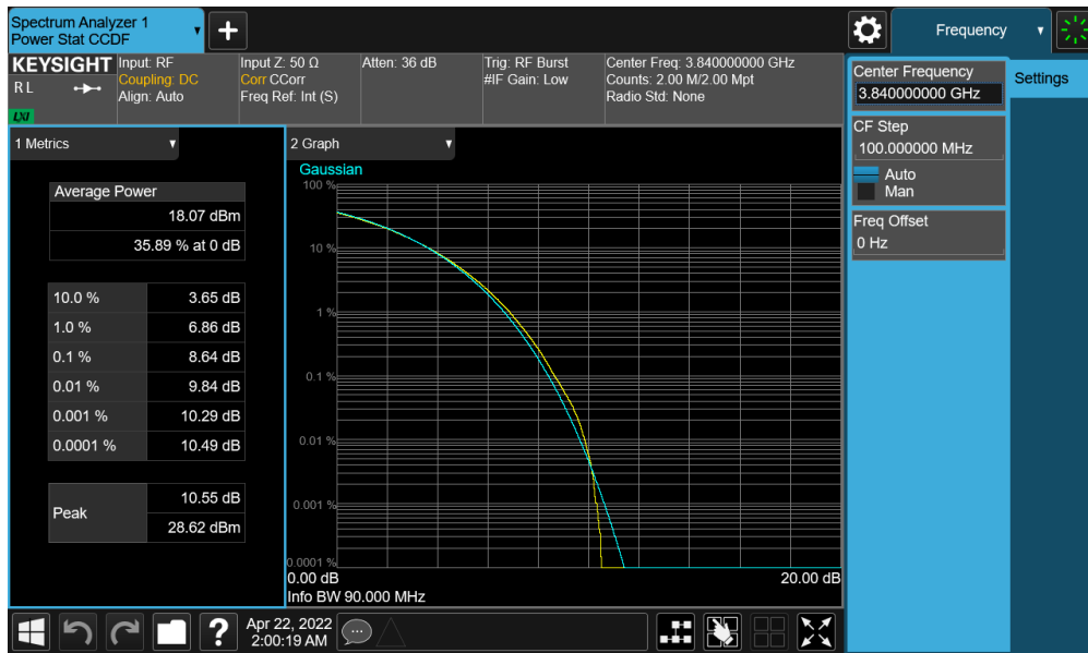
Plot 7-102. PAR Plot (NR Band n77 - 90MHz CP-OFDM 256-QAM - Full RB - ANT2)
