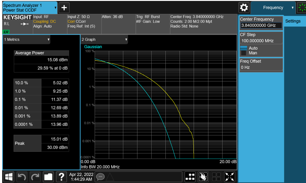
Plot 7-123. PAR Plot (NR Band n77 - 20MHz CP-OFDM 256-QAM - Full RB - ANT2)
