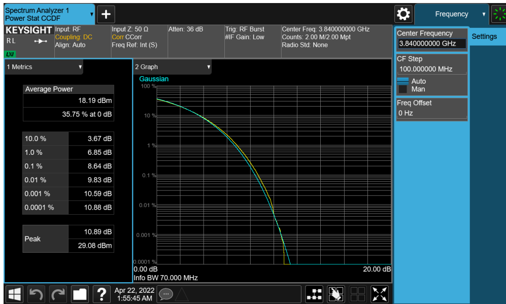
Plot 7-108. PAR Plot (NR Band n77 - 70MHz CP-OFDM 256-QAM - Full RB - ANT2)
