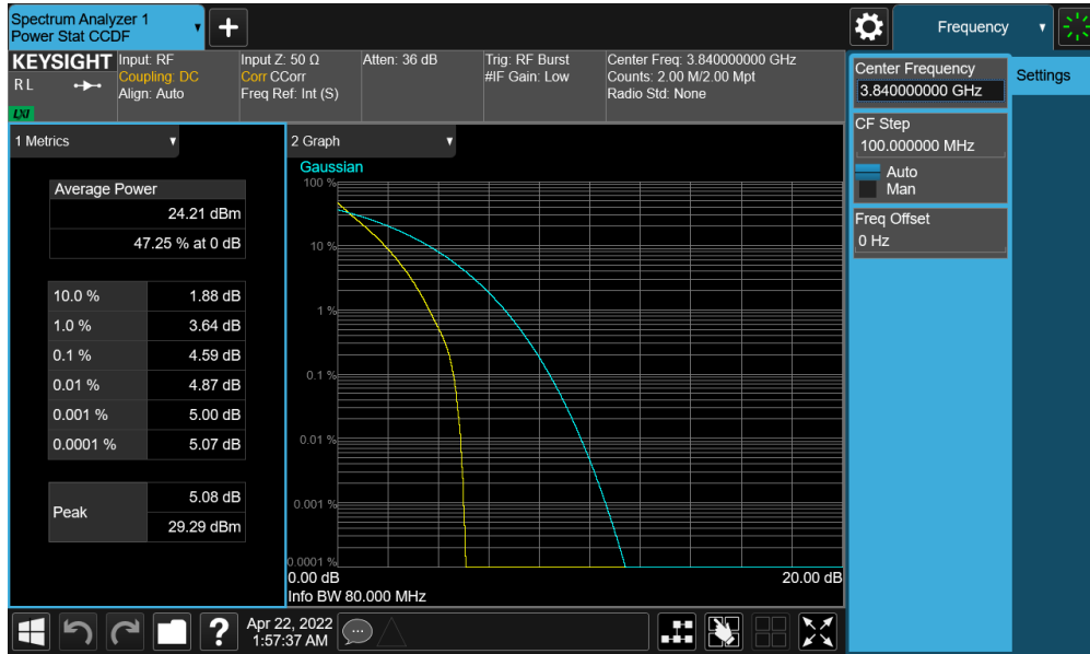
Plot 7-103. PAR Plot (NR Band n77 - 80MHz DFT-s-OFDM BPSK - Full RB - ANT2)
