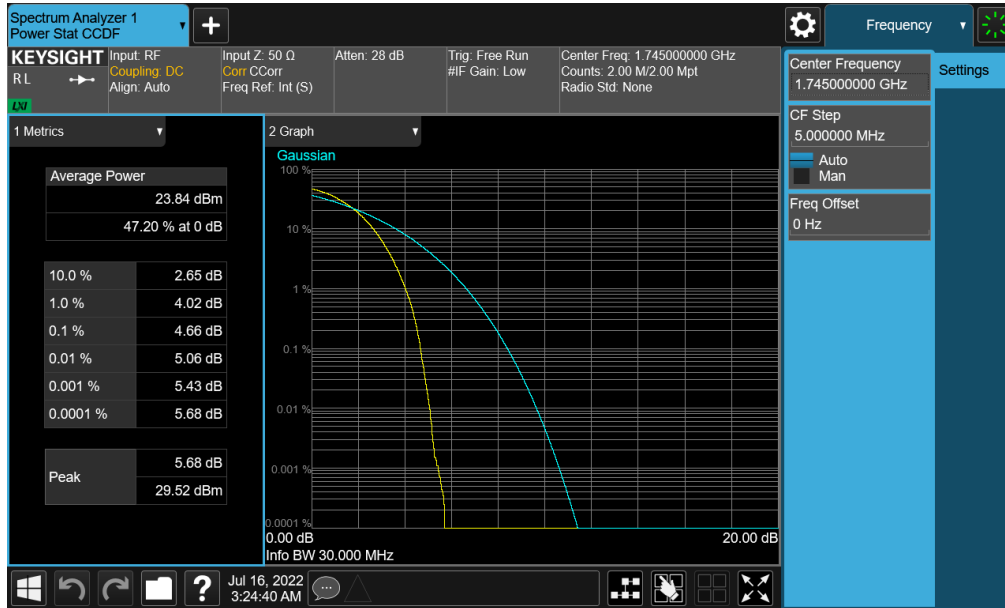
Plot 7-301. PAR Plot (NR Band n66 - 30.0MHz CP-OFDM QPSK - Full RB - Ant4)
