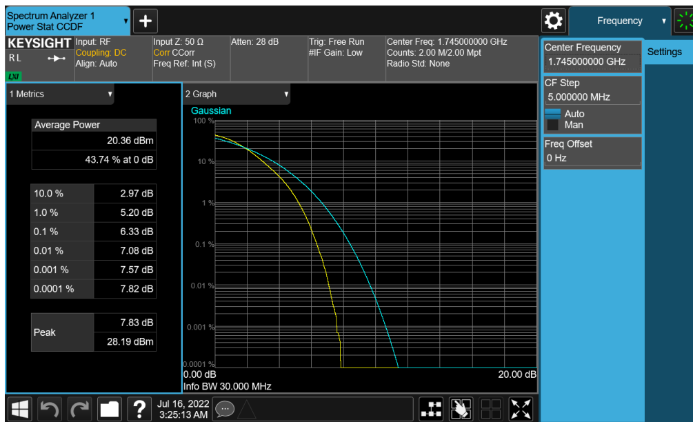
Plot 7-302. PAR Plot (NR Band n66 - 30.0MHz CP-OFDM 256-QAM - Full RB - Ant4)
