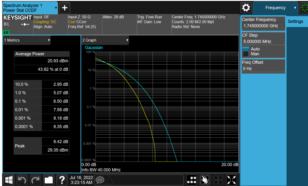
Plot 7-299. PAR Plot (NR Band n66 - 40.0MHz CP-OFDM 256-QAM - Full RB - Ant4)
