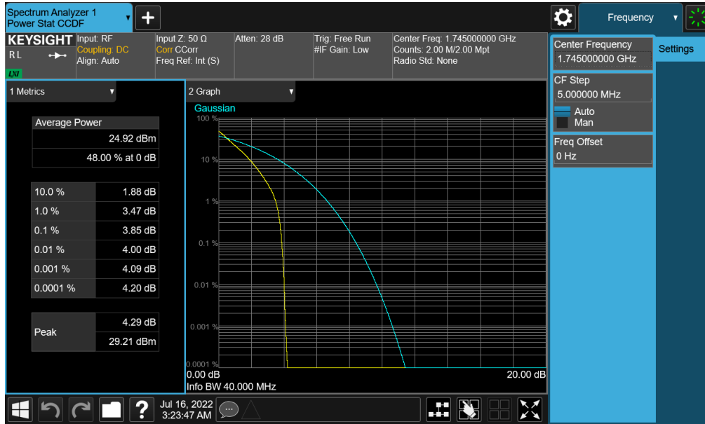
Plot 7-297. PAR Plot (NR Band n66 - 40.0MHz DFT-s-OFDM BPSK - Full RB - Ant4)
