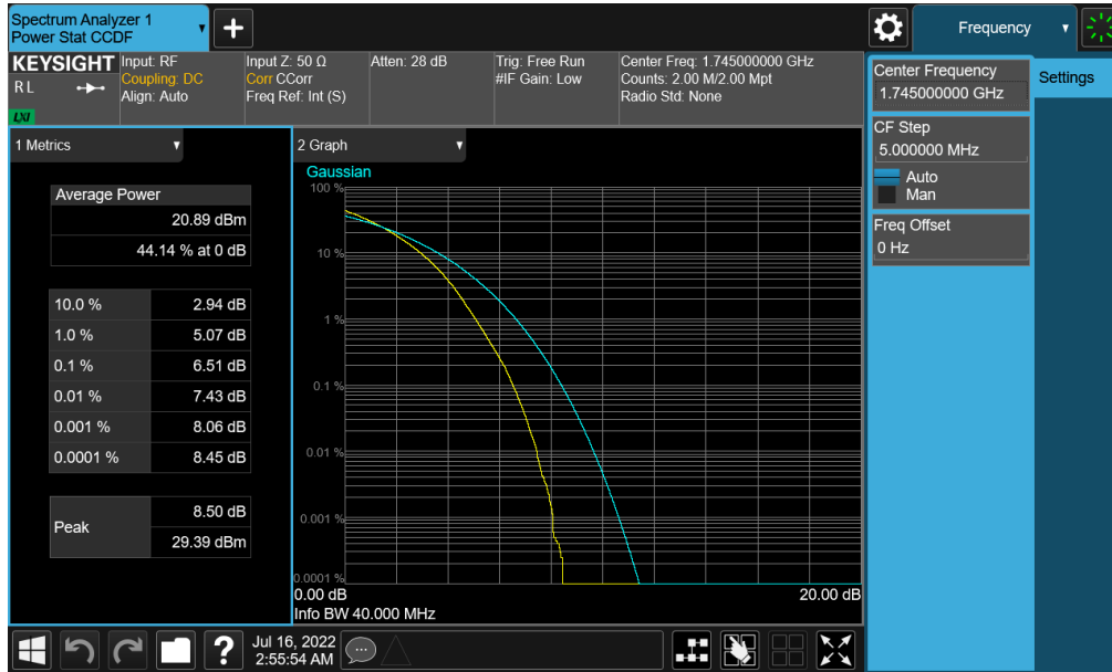
Plot 7-281. PAR Plot (NR Band n66 - 40.0MHz CP-OFDM 256-QAM - Full RB - Ant1)
