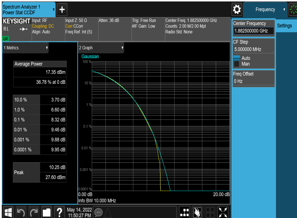
Plot 7-254. PAR Plot (NR Band n25/2 - 10.0MHz CP-OFDM 16-QAM - Full RB - ANT4)
