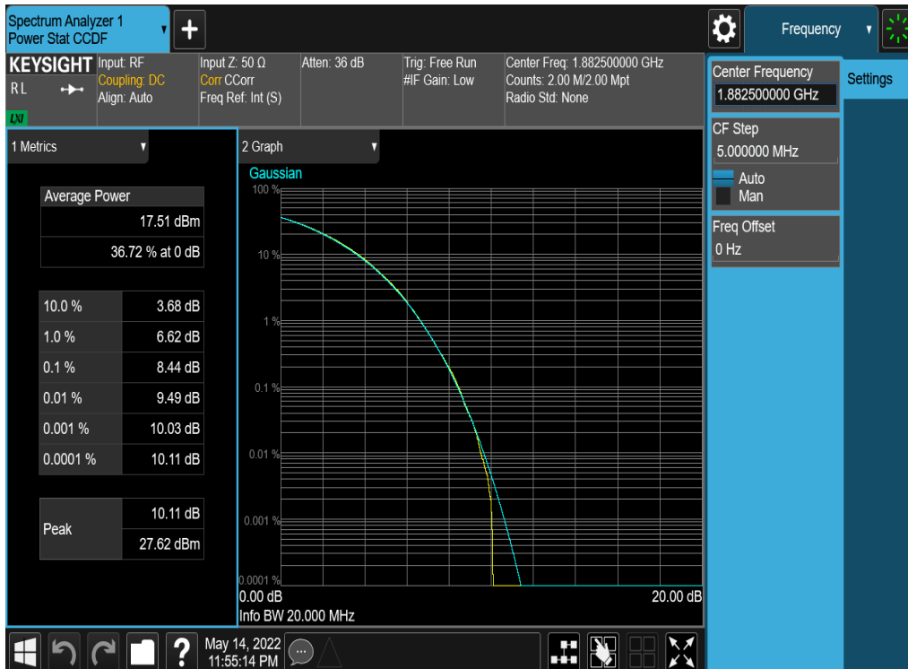
Plot 7-248. PAR Plot (NR Band n25/2 - 20.0MHz CP-OFDM 16-QAM - Full RB - ANT4)
