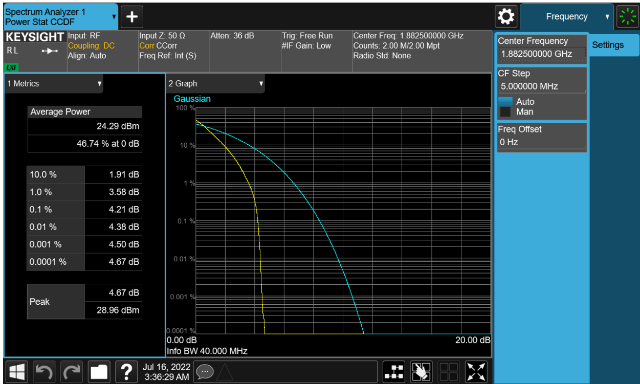
Plot 7-237. PAR Plot (NR Band n25 - 40.0MHz DFT-s-OFDM BPSK - Full RB - ANT4)
