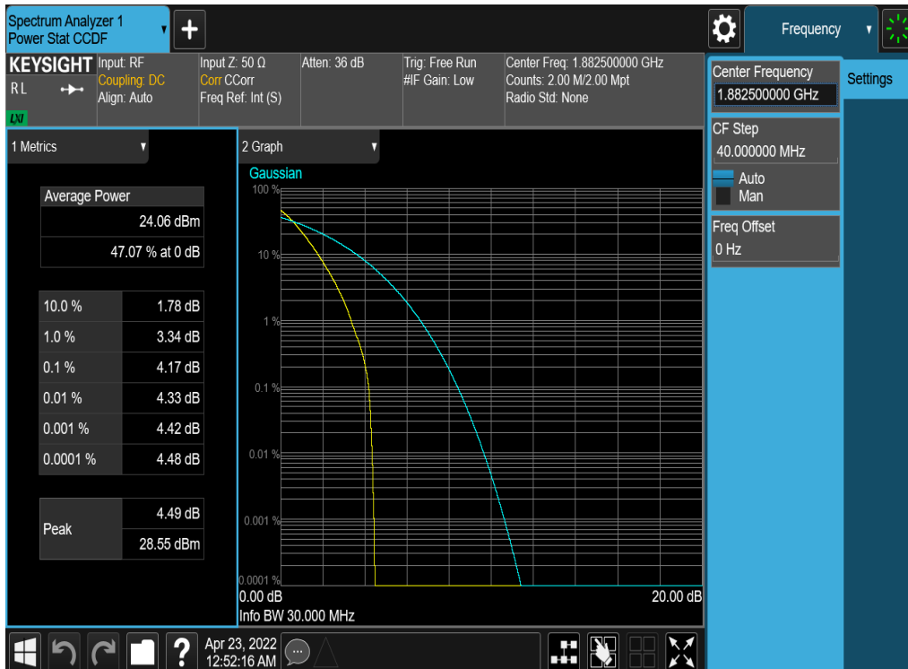
Plot 7-219. PAR Plot (NR Band n25 - 30.0MHz DFT-s-OFDM BPSK - Full RB - ANT1)
