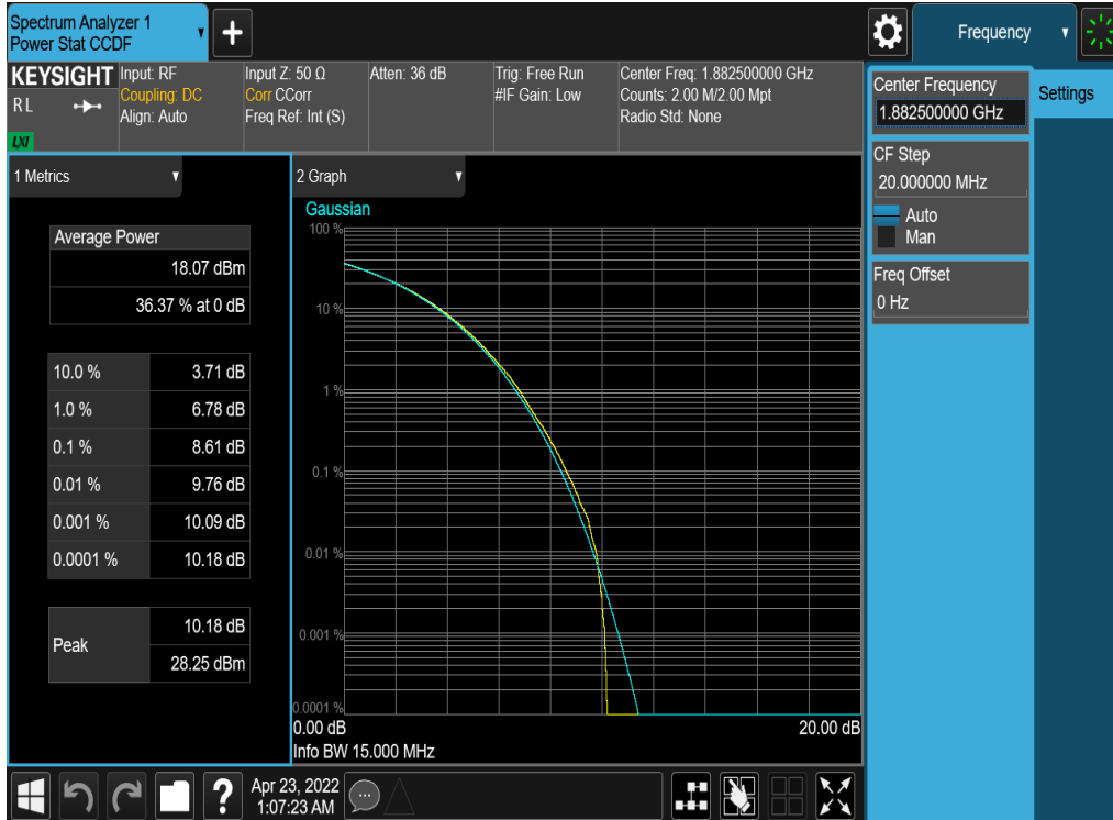
Plot 7-230. PAR Plot (NR Band n25/2 - 15.0MHz CP-OFDM 16-QAM - Full RB - ANT1)
