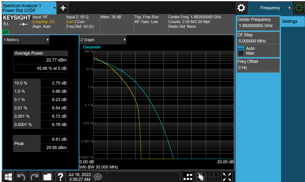
Plot 7-242. PAR Plot (NR Band n25 - 30.0MHz CP-OFDM 16-QAM - Full RB - ANT4)
