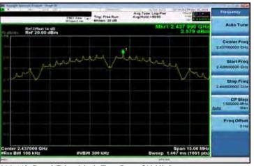
802.11b Band Edge Limit Test Data CH-High 2472Mhz
