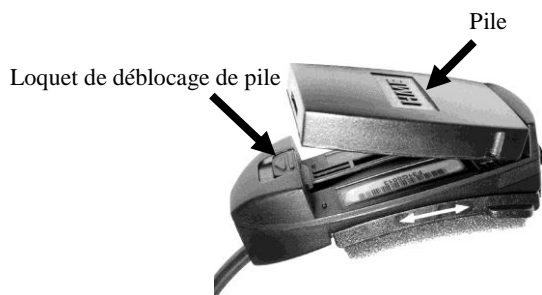
Figure 7. Piles dans le port de charge
