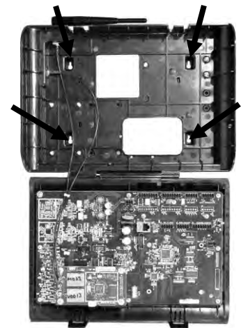
Figure 14. Poste de base ouvert, les quatre trous de vis apparents
