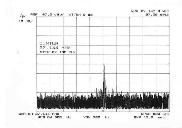
OCCUPIED BANDWIDTH PLOT (2CH)
