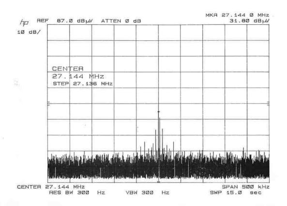
OCCUPIED BANDWIDTH PLOT (1CH)
