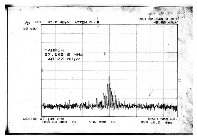
OCCUPIED BANDWIDTH PLOT (2CH)
