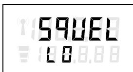
The display shows in the upper line alternately »SET« and »SQUEL«, in the lower line »LO«, »MED1«, »MED2« or »HI«.
