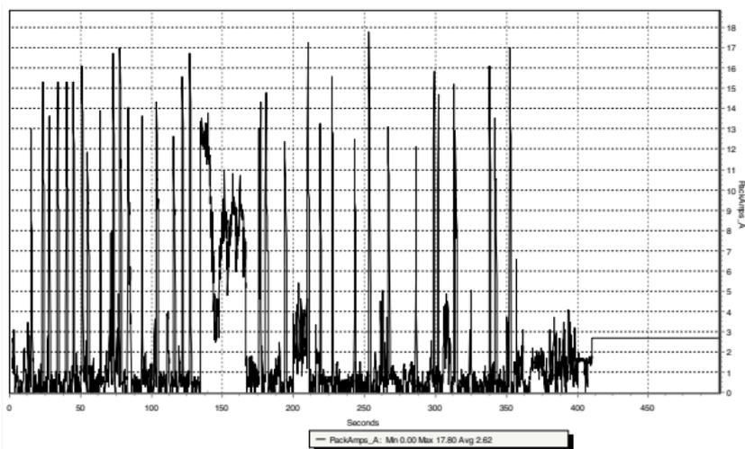
Dans l'exemple ci-dessus, l'intensité moyenne est de 2.62A et la consommation de 435mA pour 10 minutes (durée de vol typique). Il est recommandé de ne pas dépasser 60% de la capacité totale afin de conserver de la réserve. Dans cet exemple, nous utilisons deux batteries 4000mA (8000mA au total)  $\times 60\% = 4800\text{mA}$  (capacité utilisable) divisée par la capacité utilisée pour 10 minutes de vol (435mA), nous pouvons effectuer jusqu'à 11 vols de 10 minutes chacun.
