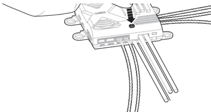
4. La procedura di connessione è completa quando il LED arancione sulla ricevente resta acceso fisso.
