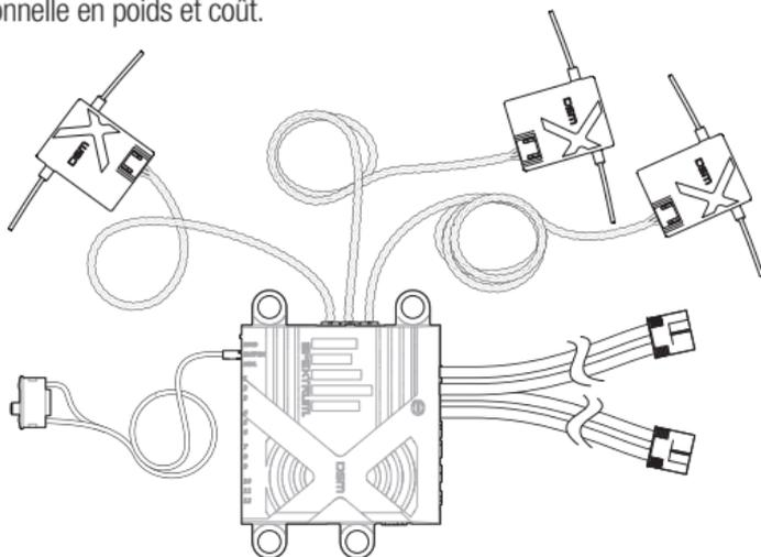
1. Utilisez de la mousse adhésive double face et des colliers pour fixer le PowerSafe à l'emplacement où vous souhaitez placer le récepteur.
