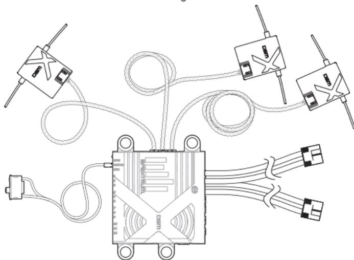
1. Bitte benutzen Sie geschäumtes doppelseitiges Klebeband und Kabelbinde-der um die die PowerSafe Einheit zu befestigen. Wählen Sie als Einbauort den Platz, wo normalerweise auch der Empfänger eingebaut wird.
