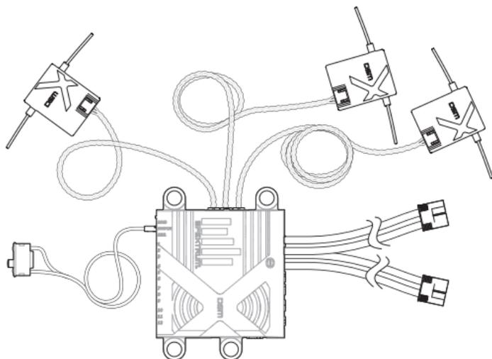
1. Sistemare il PowerSafe fissandolo con biadesivo e fascette dove di solito si metterebbe il ricevitore.
