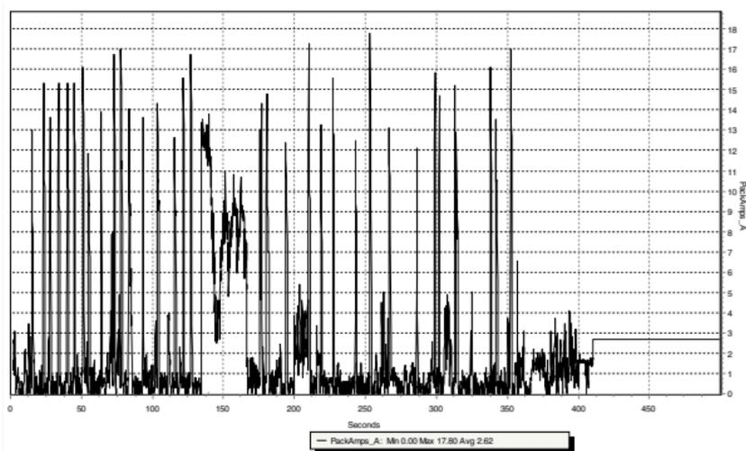
Nell'esempio qui sopra, la corrente media era 2,62 A, per cui si calcola un consumo di 435 mAh per un volo tipico di 10 minuti. Si raccomanda di usare solo il 60% della potenza disponibile per avere una buona riserva di capacità della batteria. In questo esempio usando due batterie da 4000 mAh (capacità totale 8000 mAh)  $\times$  60% = 4800 mAh (capacità disponibile utilizzabile) diviso per 435 mAh (capacità usata in 10 minuti di volo), si ottengono fino a 11 voli da 10 minuti ciascuno.
