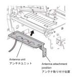
Tip: Align the four corners of the antenna unit to the notches indicated by the circles. **補足:** アンテナユニットの四隅を、下図の丸で示した位置にある切り欠きに合わせます。
