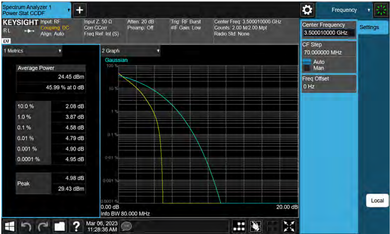
Sub6 n77(78). PAR Plot (80 M BW_Ch.633334_BPSK)
