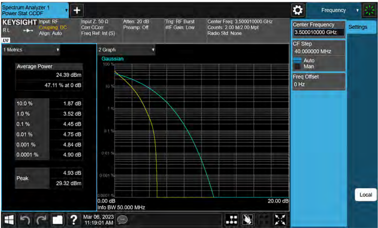
Sub6 n77(78). PAR Plot (50 M BW_Ch.633334_BPSK)
