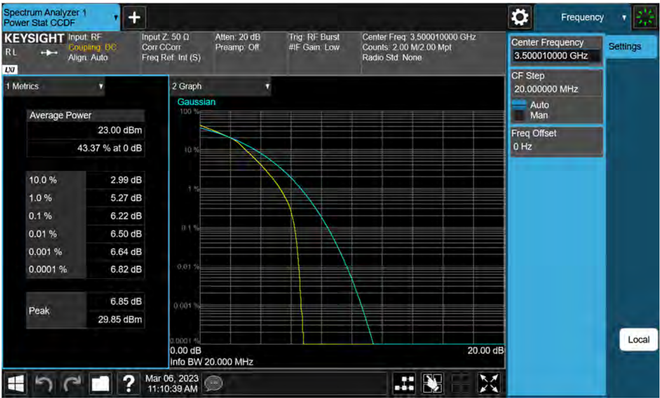
Sub6 n77(78). PAR Plot (20 M BW_Ch.633334_16QAM)
