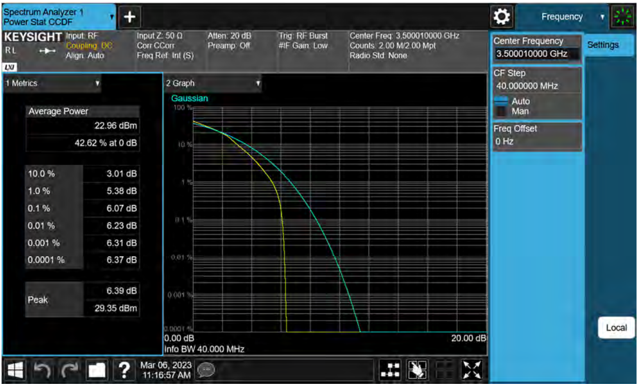
Sub6 n77(78). PAR Plot (40 M BW_Ch.633334_16QAM)
