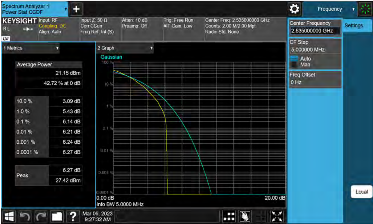
Sub6 n7. PAR Plot (5 M BW_Ch.507000_64QAM)
