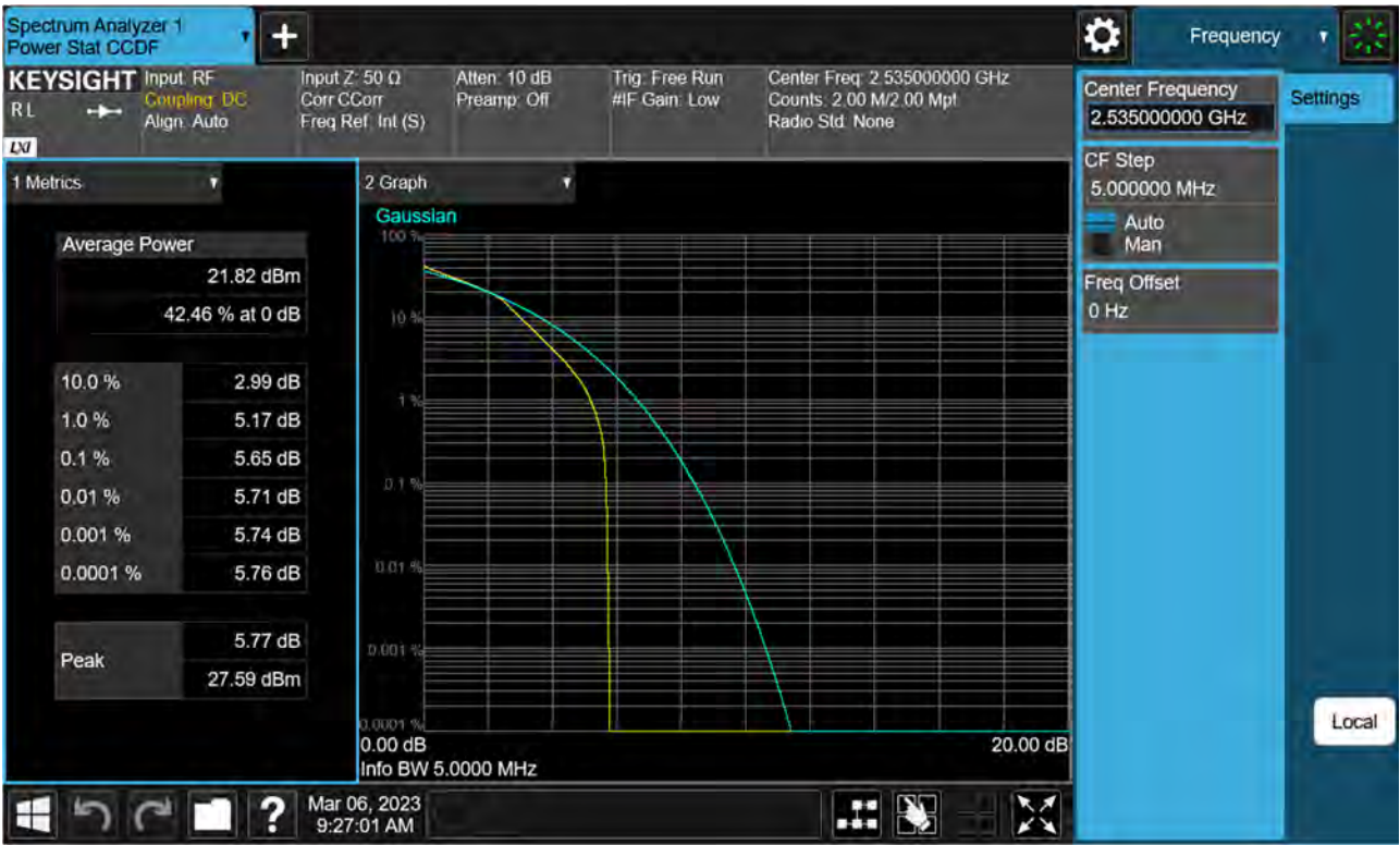
Sub6 n7. PAR Plot (5 M BW_Ch.507000_16QAM)
