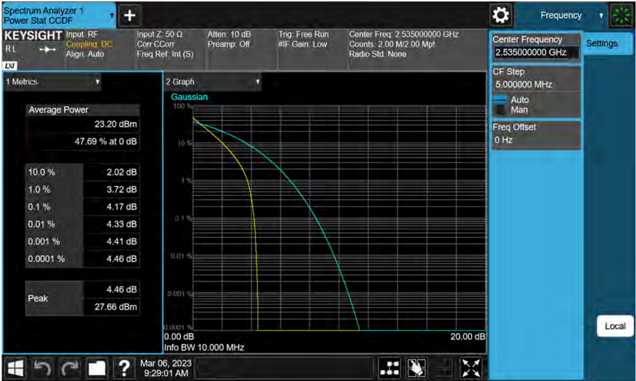
Sub6 n7. PAR Plot (10 M BW_Ch.507000_BPSK)
