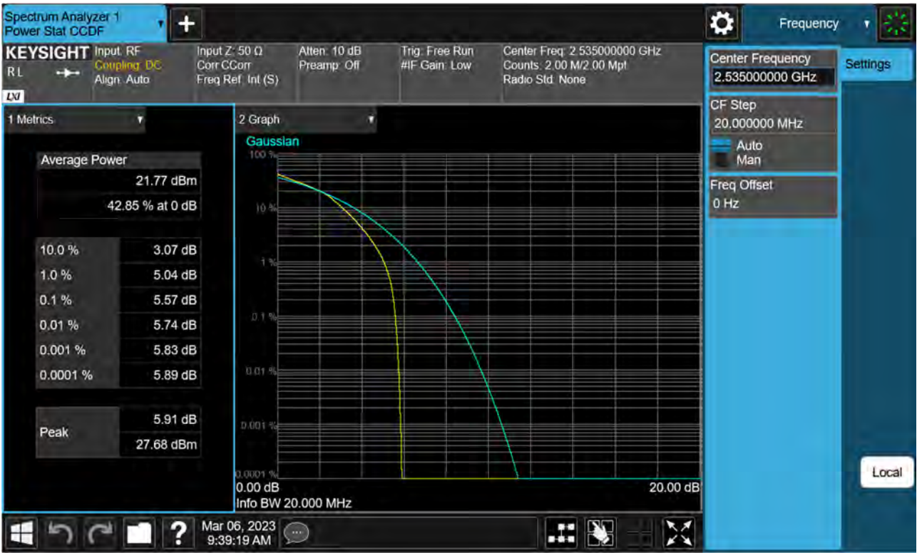
Sub6 n7. PAR Plot (20 M BW_Ch.507000_16QAM)
