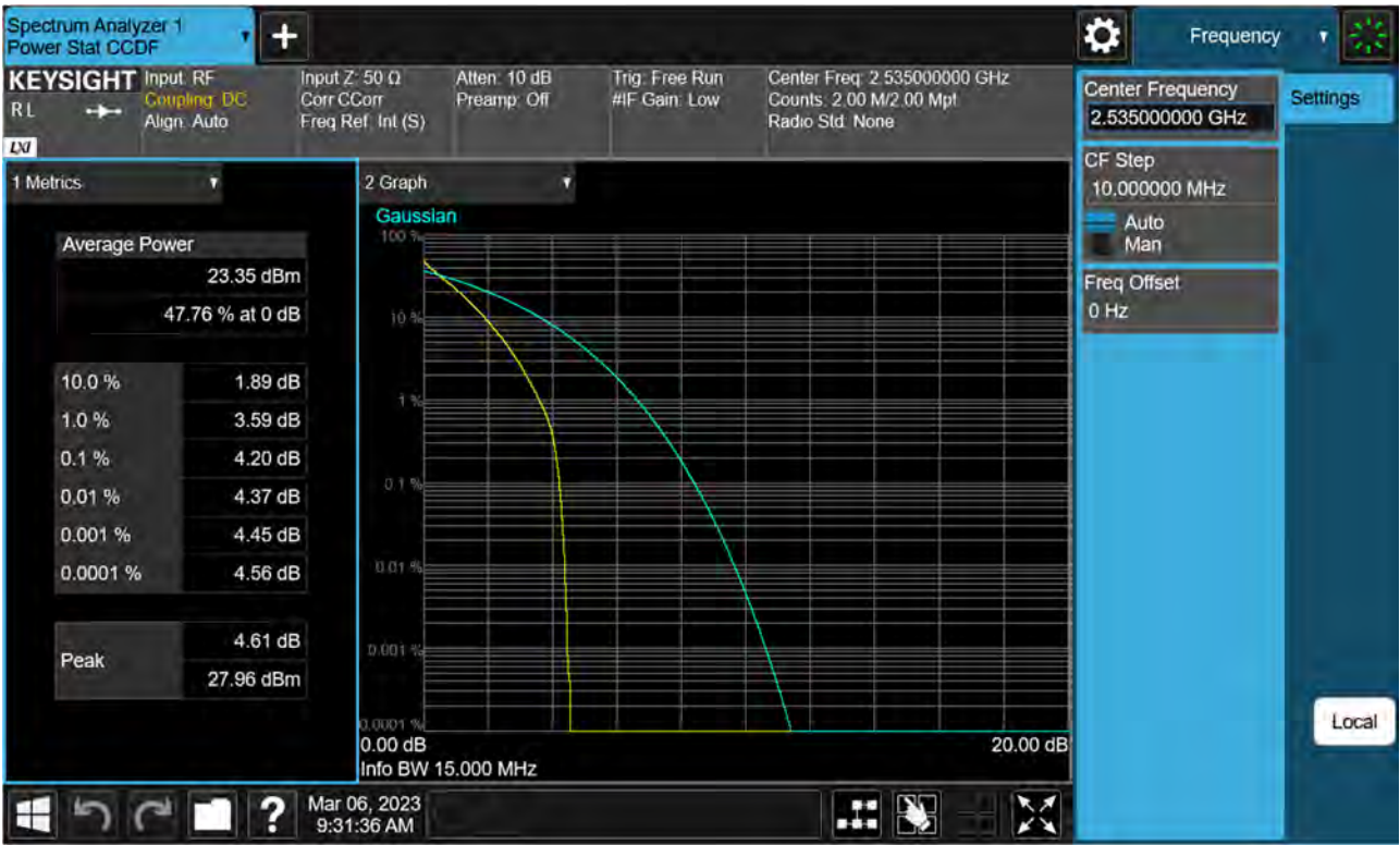
Sub6 n7. PAR Plot (15 M BW_Ch.507000_BPSK)
