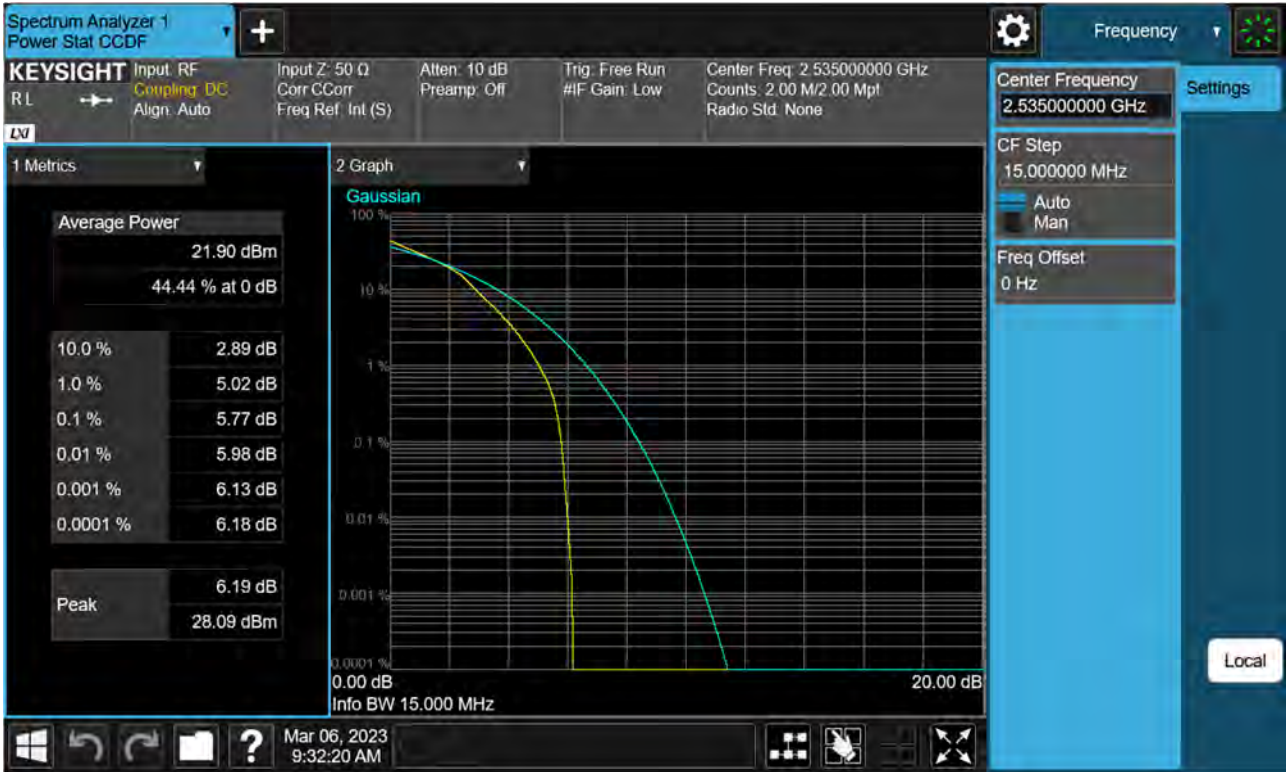
Sub6 n7. PAR Plot (15 M BW_Ch.507000_16QAM)
