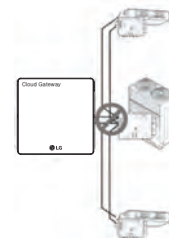
<Exemple incorrect : Connexion au format RS485 STAR>
