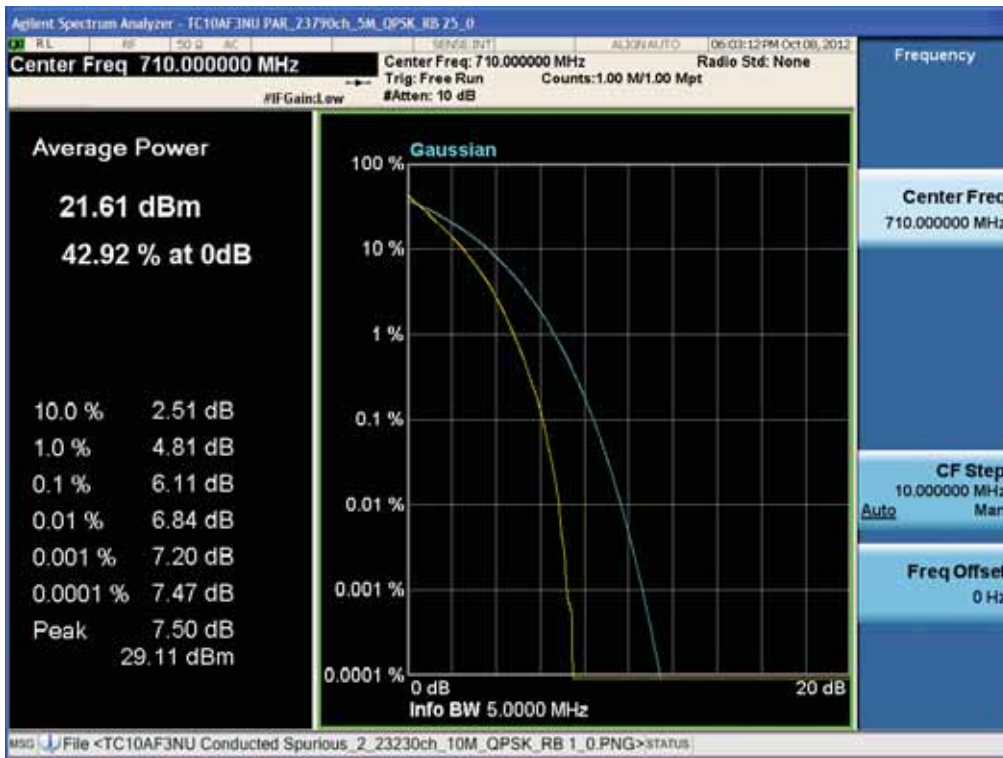
BAND 17. PAR Plot (23790ch_5MHz_QPSK_RB 25)
