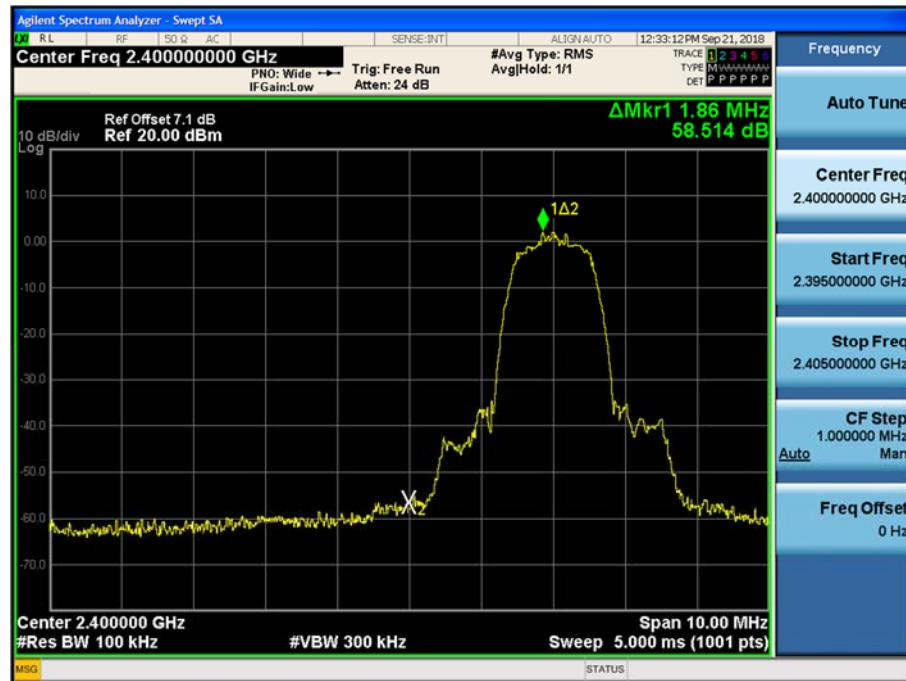
Test Plots without hopping ( $\pi/4$ DQPSK)
