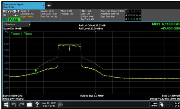
Figure 199- A(Core 0) 802.11ax HE160 SU SP 6345 MHz (CH79)
