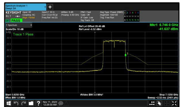
Figure 206 - B(Core 1) 802.11ax HE160 SU LPI 6665 MHz (CH143)
