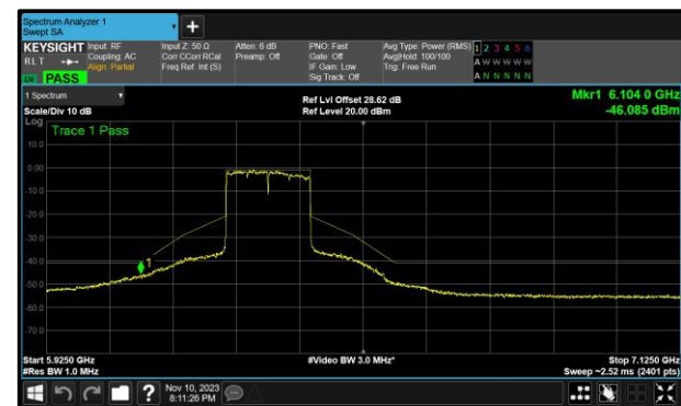
Figure 212 - A(Core 0) 802.11ax HE160 SU SP 6345 MHz (CH79)
