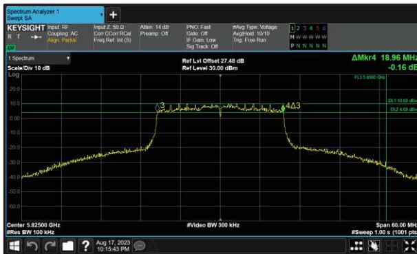
Figure 228 - 802.11ax HE20 SU Minimum 6 dB EBW
