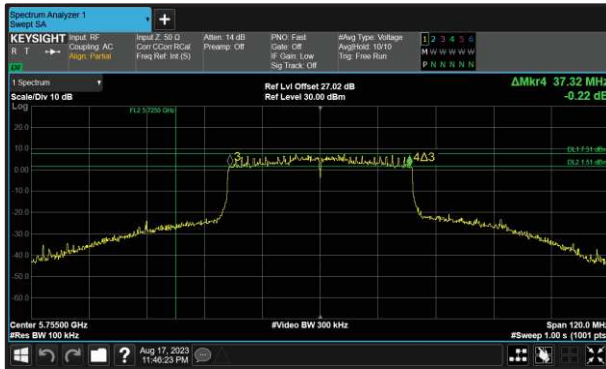
Figure 260 - 802.11ax HE40 SU Minimum 6 dB EBW
