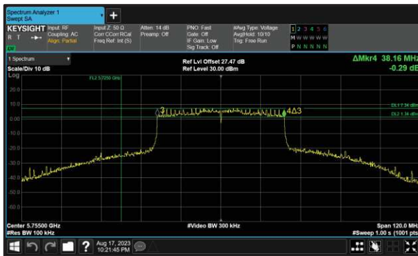
Figure 230 - 802.11ax HE40 SU Minimum 6 dB EBW
