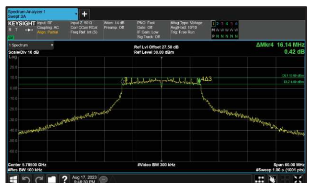
Figure 221 - 802.11a Maximum 6 dB EBW
