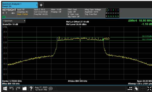
Figure 262 - 802.11ax HE20 SU Minimum 6 dB EBW
