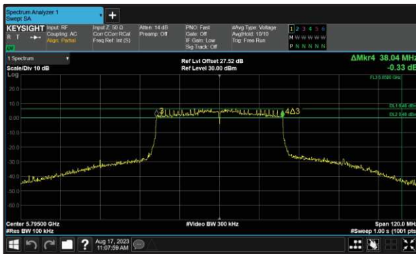
Figure 234 - 802.11ax HE40 SU Minimum 6 dB EBW
