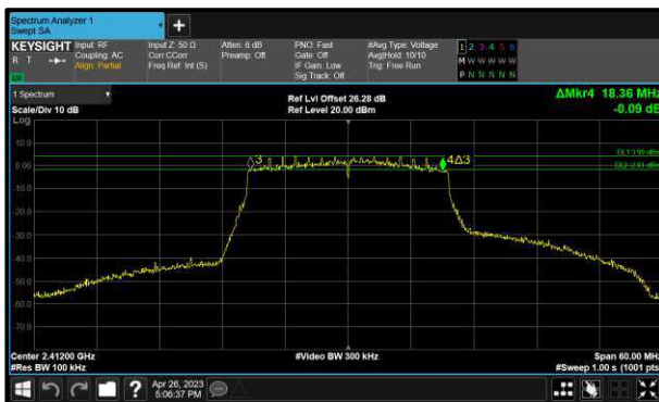
Figure 71 - 802.11ax HE20 SU Minimum 6 dB EBW
