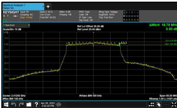
Figure 59 - 802.11ax HE20 SU Minimum 6 dB EBW
