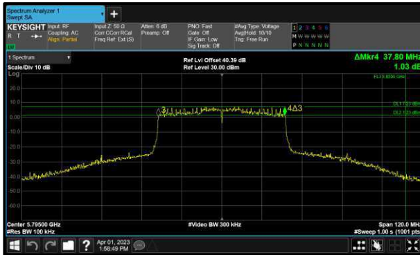
Figure 200 - 802.11ax HE40 SU Minimum 6 dB EBW
