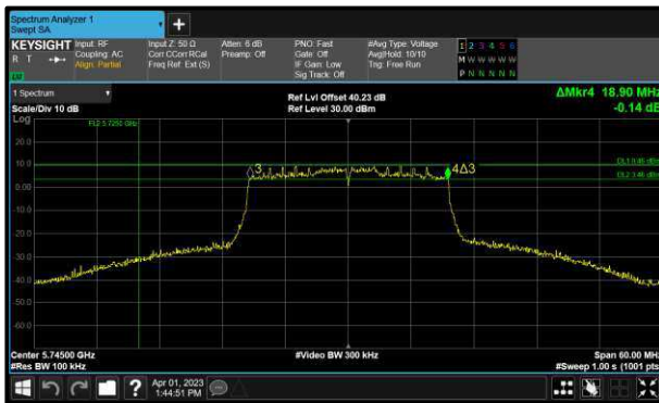
Figure 198 - 802.11ax HE20 SU Minimum 6 dB EBW
