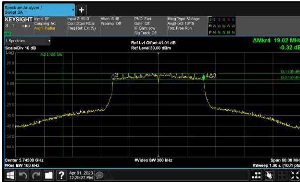
Figure 168 - 802.11ax HE20 SU Minimum 6 dB EBW
