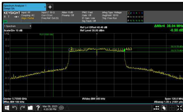
Figure 187 - 802.11ax HE40 SU Minimum 6 dB EBW
