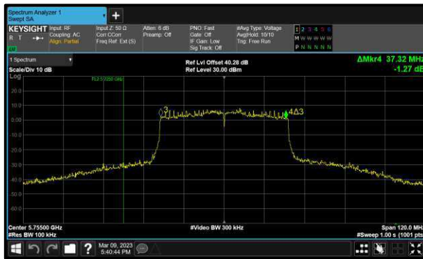
Figure 217 - 802.11ax HE40 SU Minimum 6 dB EBW
