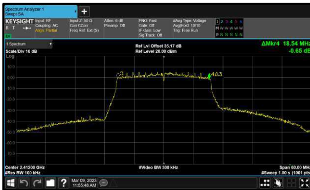
Figure 59 - 802.11ax HE20 SU Minimum 6 dB EBW
