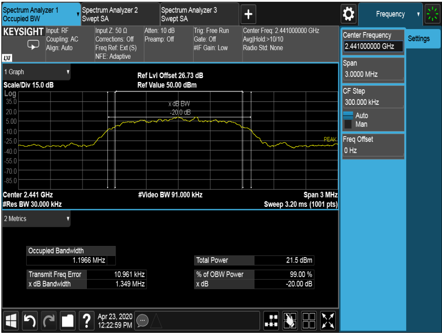
Figure 43 - 2441 MHz - \pi/4 DQPSK
