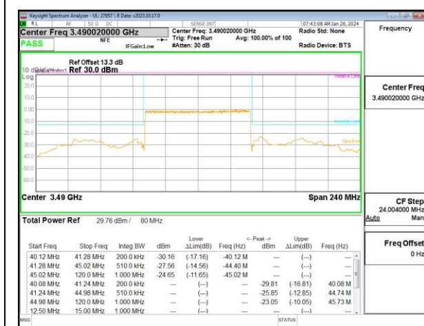
5G NR n77 80MHz BPSK Low Channel RB216-0
