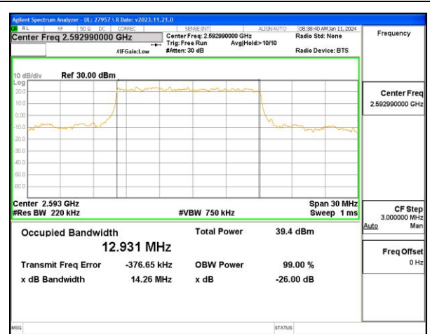
5G NR n41 15MHz BPSK Middle Channel RB36-0
