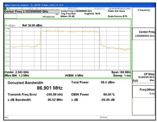
5G NR n41 90MHz BPSK Middle Channel RB243-0
