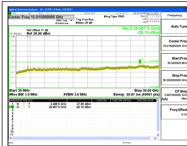
5G NR n41 100MHz BPSK Low Channel RB1-0
