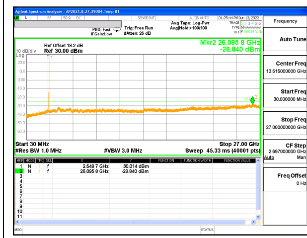
LTE B7 20MHz + 20MHz QPSK High Ch RB1-99 + RB1-0
