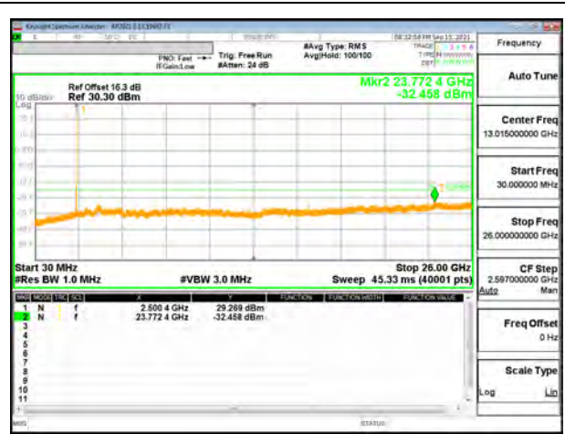
5G NR n7 20MHz BPSK Low Channel RB1-0
