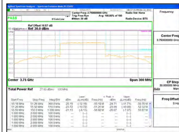
5G NR n77 100MHz BPSK Low Channel RB270-0
