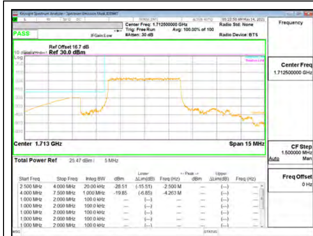
5G NR n66 5MHz BPSK Low Channel RB25-0
