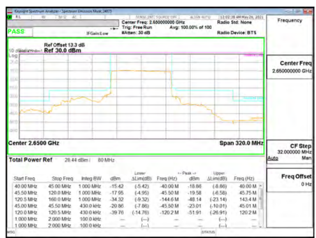
5G NR n41 80MHz BPSK High Channel RB216-0
