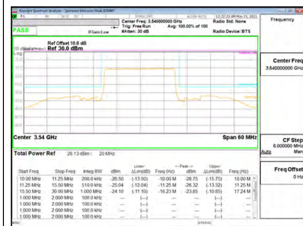
5G NR n77 20MHz BPSK High Channel RB50-0
