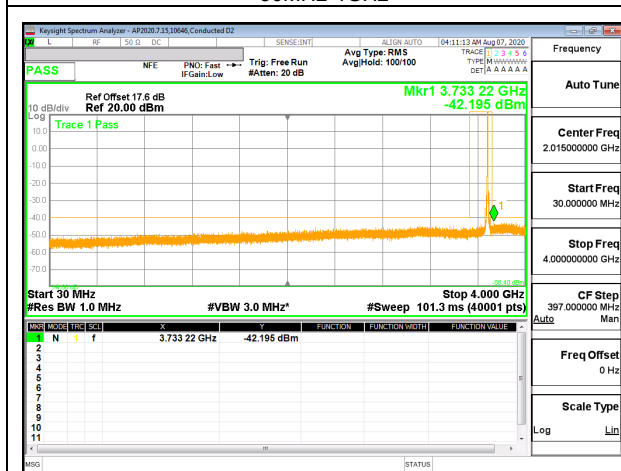
LTE B48 20MHz + 20MHz QPSK High Ch RB1-99 + RB1-0 30MHz-4GHz
