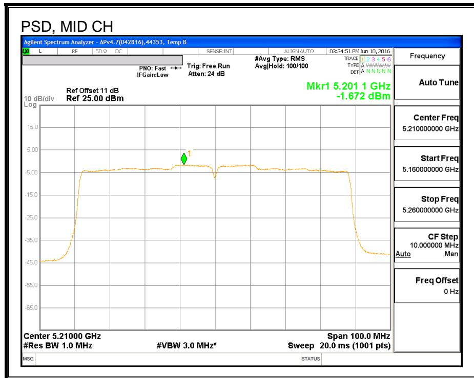
**7.9. 802.11ac VHT80 2Tx CDD MODE IN THE 5.2 GHz BAND****7.9.1. 26 dB BANDWIDTH****LIMITS**
