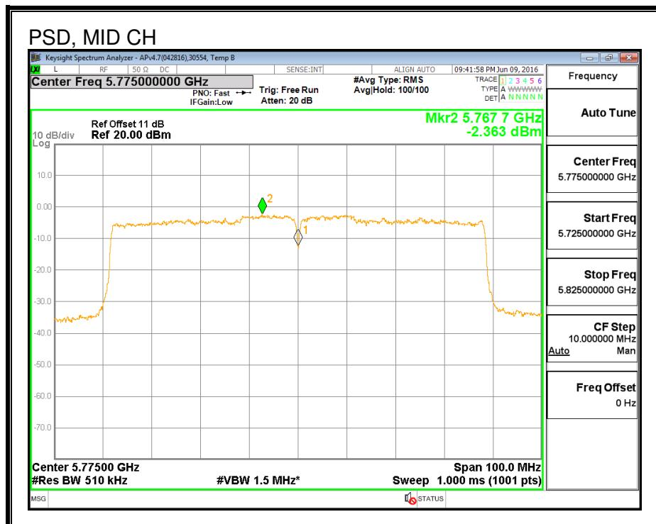
**7.58. 802.11ac VHT80 2Tx STBC MODE IN THE 5.8 GHz BAND**
