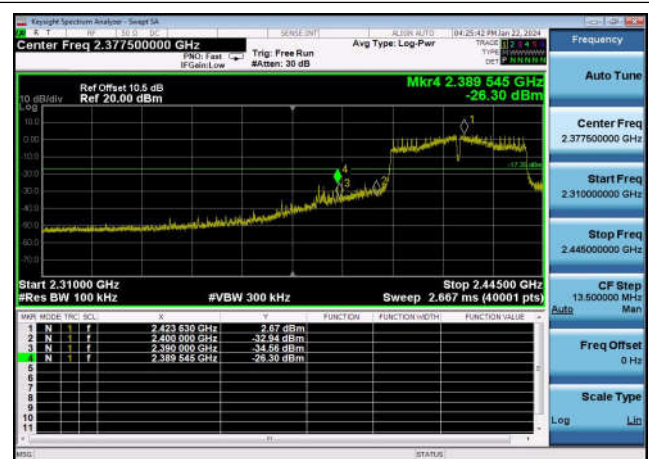
,Plot 2,Band Edge-802.11n(HT40) ,2452MHz,Ant0
