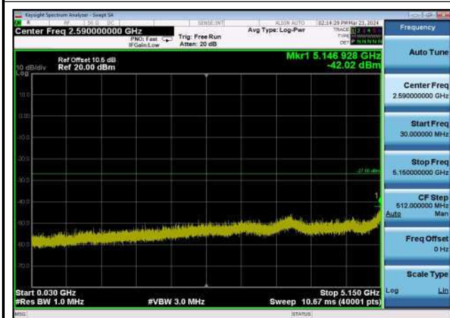
U-NII-1 ,Plot 2,30MHz~5150MHz-802.11a c(20MHz),5220MHz,Ant1
