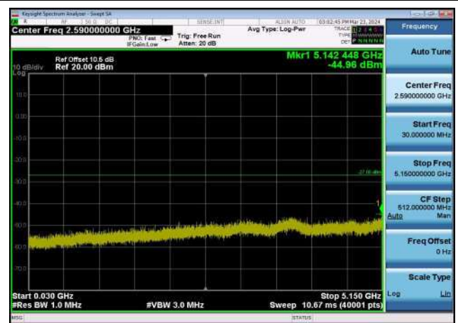
U-NII-2a ,Plot 2,30MHz~5150MHz-802.11 n(20MHz),5320MHz,Ant1
