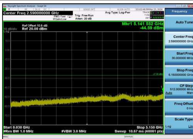
U-NII-2a ,Plot 2,30MHz~5150MHz-802.11 n(20MHz),5300MHz,Ant1
