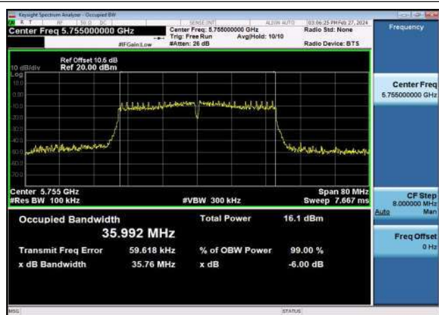
U-NII-3 6dB Bandwidth-802.11ac(40MHz) ,5755MHz,Ant1
