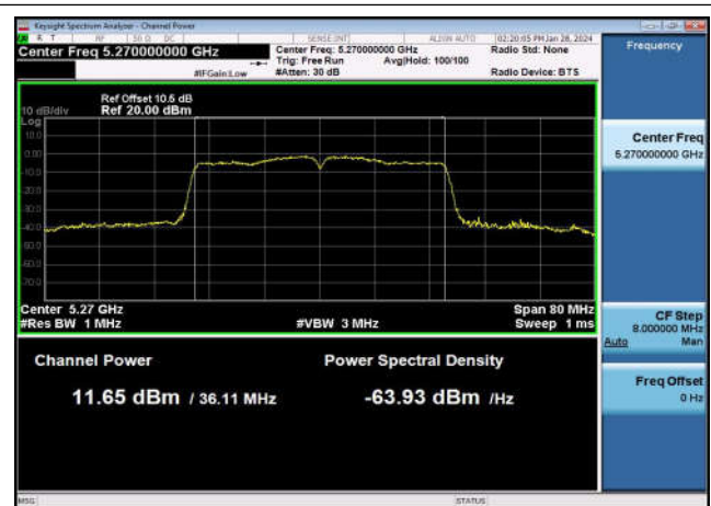
U-NII-2a Output Power-802.11n(40MHz) ,5270MHz,Ant1
