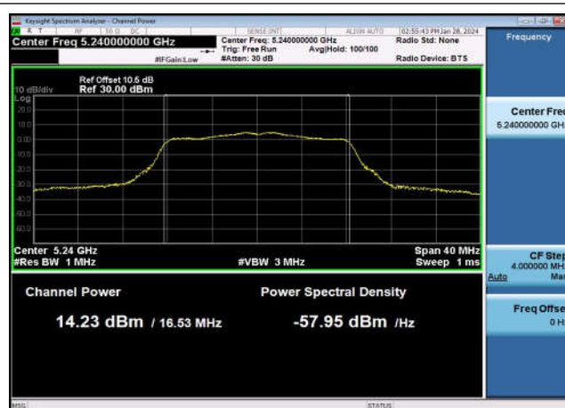
U-NII-1 Output Power-802.11ac(20MHz) ,5220MHz,Ant1
