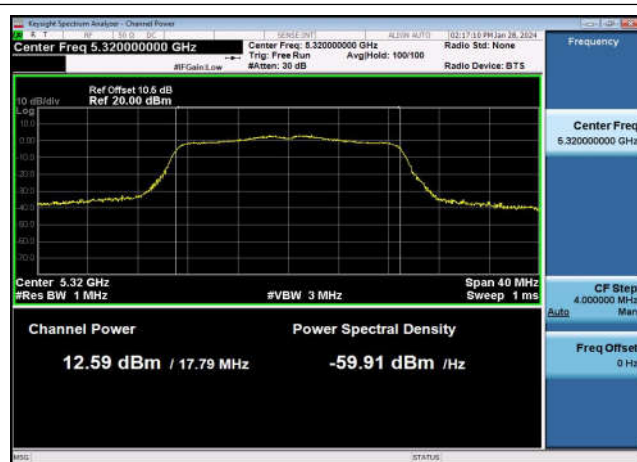
U-NII-2a Output Power-802.11n(20MHz) ,5320MHz,Ant1
