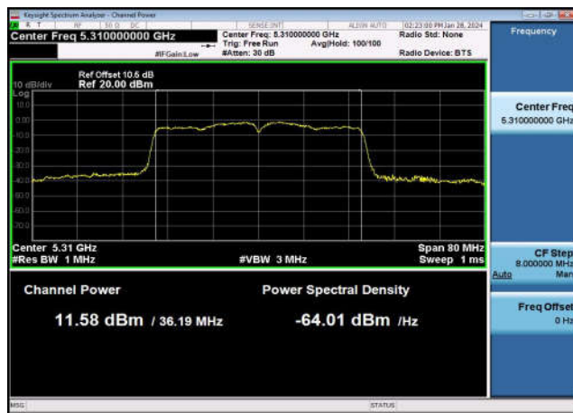
U-NII-2a Output Power-802.11a(20MHz) ,5300MHz,Ant1
