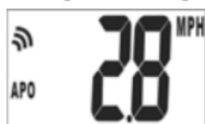
Um die Maßeinheit zu ändern, schalten Sie den myMET-Windmesser ein und halten Sie die Ein-/Aus-Taste so lange gedrückt, bis auf dem LCD-Display „SEt“ angezeigt wird (über 5
