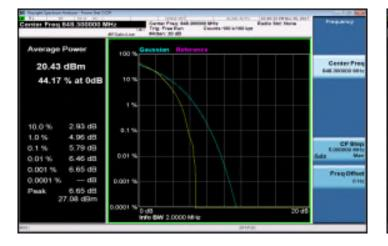
LTE Band26 3MHz 16QAM 15 0 LowCH26705-815.5
