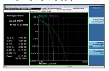
LTE Band26 10MHz 16QAM 50 0 LowCH26750-820
