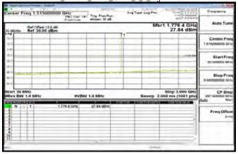
3GHz~10GHz Band66 5MHz QPSK 1 0 HighCH132647-1777.5
