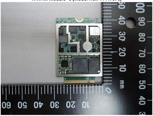
WLAN / BT Module (Model No.: 8265D2W)
