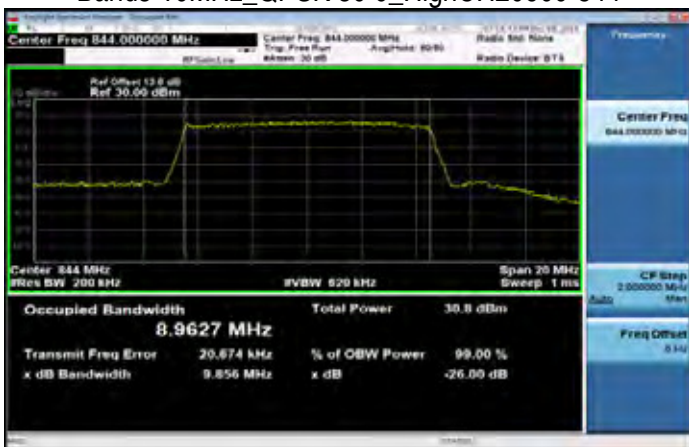
Band5 10MHz_QPSK 50 0_HighCH20600-844
