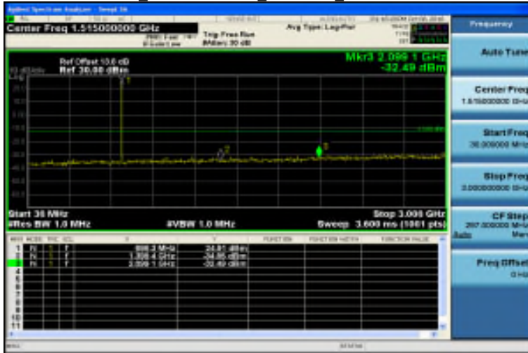
30MHz~3GHz_Band12 1.4MHz_QPSK 1 0_LowCH23017-699.7
