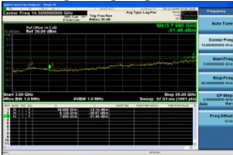
3GHz~10GHz_Band7 20MHz_QPSK 1 0_LowCH20850-2510
