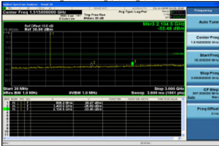
30MHz~3GHz_Band12 5MHz_QPSK 1 0_LowCH23035-701.5
