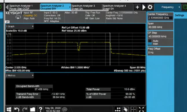
**LTE Band 7 (CA 7C), Channel Bandwidth 20MHz+20MHz**
