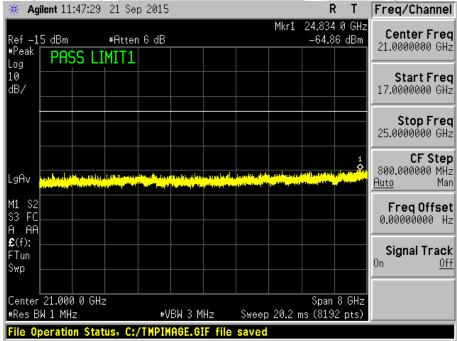
Plot 144 - Channel 1 (lower ch) @ DQPSK 2Mbps
