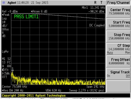
Plot 139 - Channel 1 (lower ch) @ DQPSK 2Mbps
