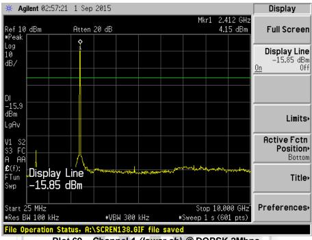
Plot 69 - Channel 1 (lower ch) @ DQPSK 2Mbps
