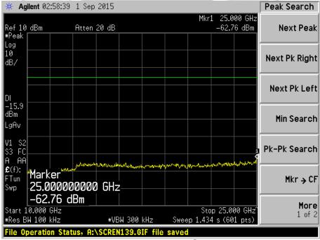
Plot 70 - Channel 1 (lower ch) @ DQPSK 2Mbps
