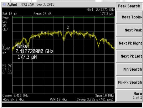
Plot 372 - Channel 1 (lower ch) @ DQPSK 2Mbps
