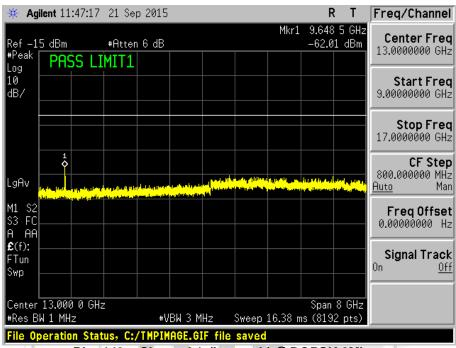
Plot 143 - Channel 1 (lower ch) @ DQPSK 2Mbps
