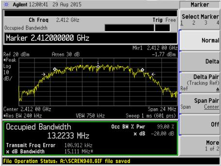
Plot 35 - Channel 1 (lower ch) @ DQPSK 2Mbps
