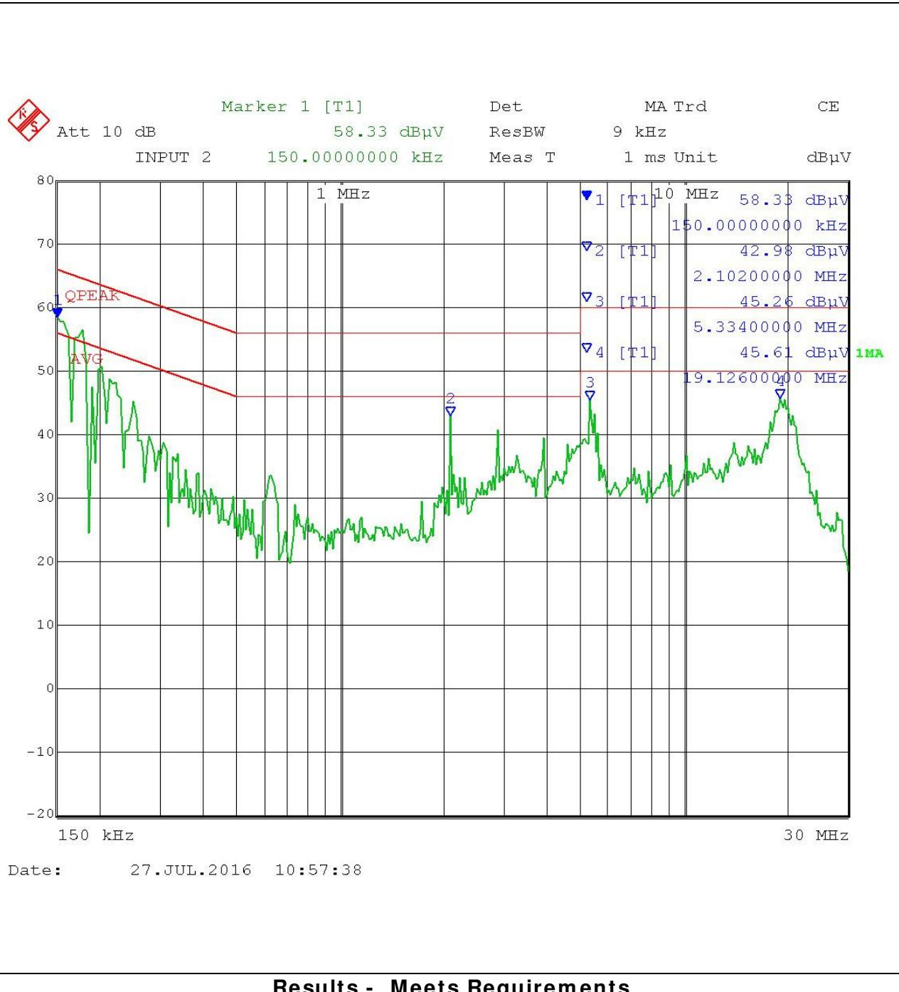
**POWER LINE CONDUCTED INTERFERENCE**
