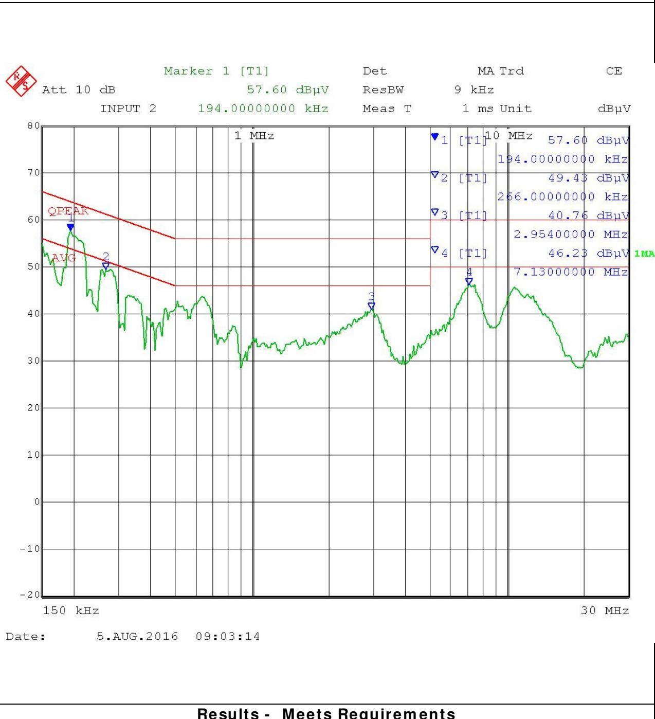
**POWER LINE CONDUCTED INTERFERENCE**
